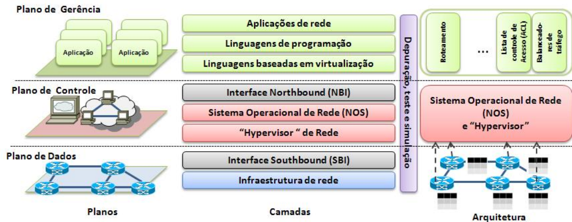
Figura 5.12. Diagrama de arquitetura de sistema de rede SDN.
