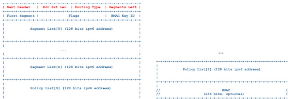
Figura 5.31. Cabeçalho de Roteamento por Segmentos SRH do IPv6.
